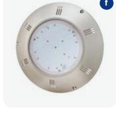
067113      (e) Flachscheinwerfer 60 LED kaltweiss (1450 Lumen), 6'500 K, ON/OFF, 13 Watt, mit weisser Blende und 2 m Kabel vormontiert      160.00
