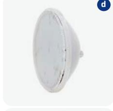
067116\*      (d) Standard 90 LED Lampe RGB (512 Lumen), PAR 56, Fernbedienung, Farbwechsel durch ON/OFF-Schaltung, 11 fixe Farben, 5 autom. Programme, 16 Watt, Winkel ca. 120°      188.00
